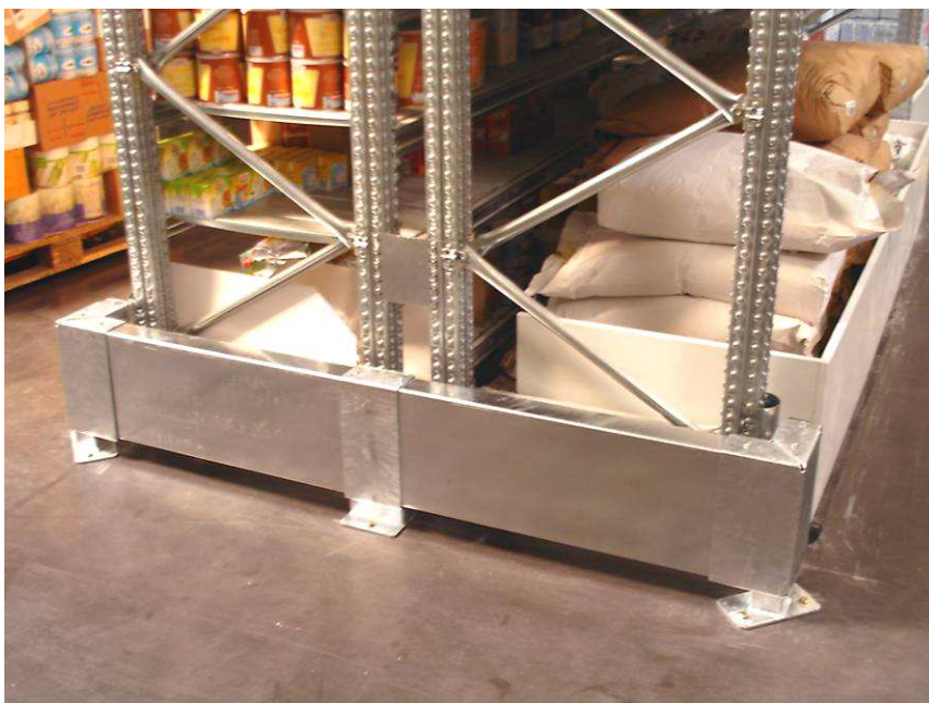
Protection des racks
